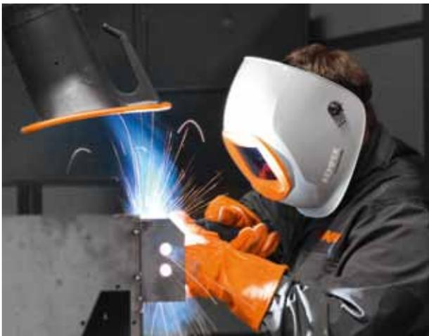
Der KEMPER autodark® -Schweißer- Schutzschirm zeichnet sich durch den hohen Tragekomfort aus. Er lässt sich individuell an die Kopfform anpassen und bietet auch Brillenträgern einen komfortablen und optimalen Schutz. Alle Bedienelemente sind außerhalb der Helmschale angebracht. Das erleichtert die Bedienung erheblich.
