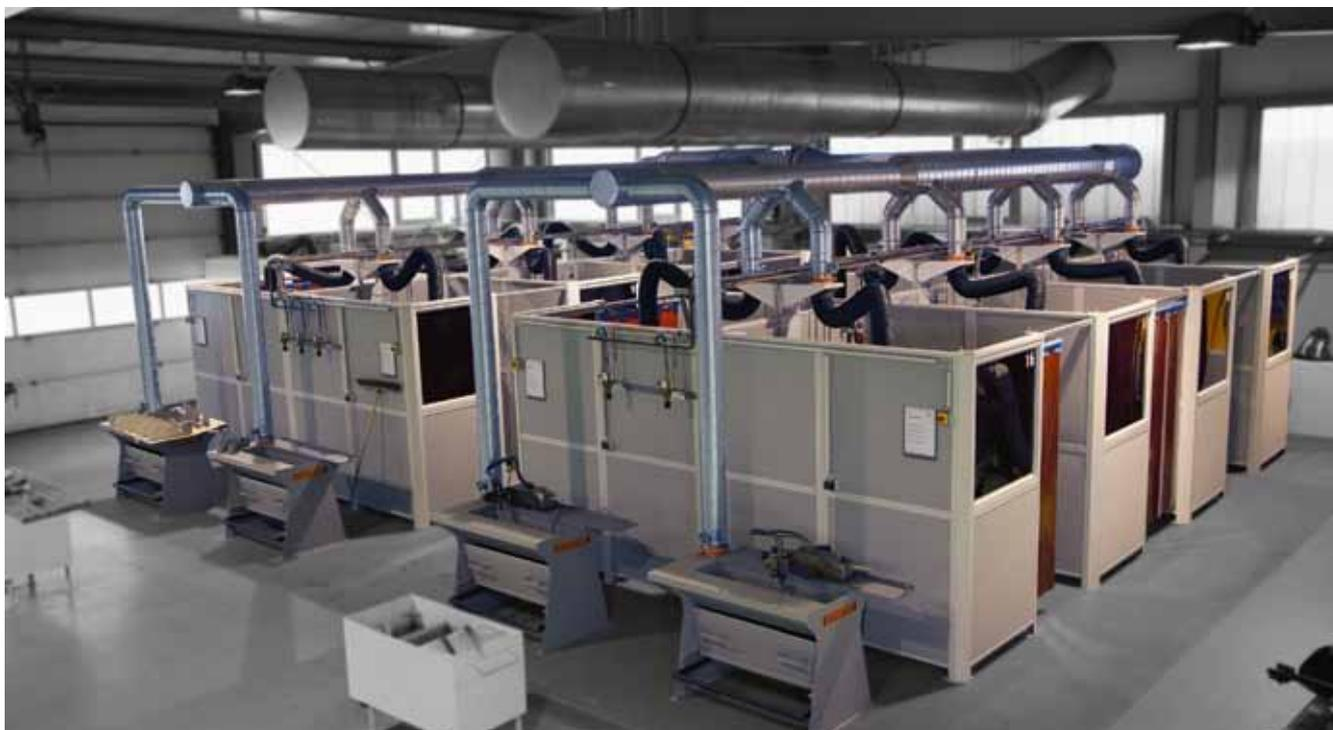
Das KEMPER Schallschutz- und Trennwandsystem ist aus verschiedenen Systemelementen beliebig kombinierbar. Stützen und Querstreben bestehen aus Profilstahl und sind mit UV Strahlen hemmender Pulverbeschichtung versehen.
