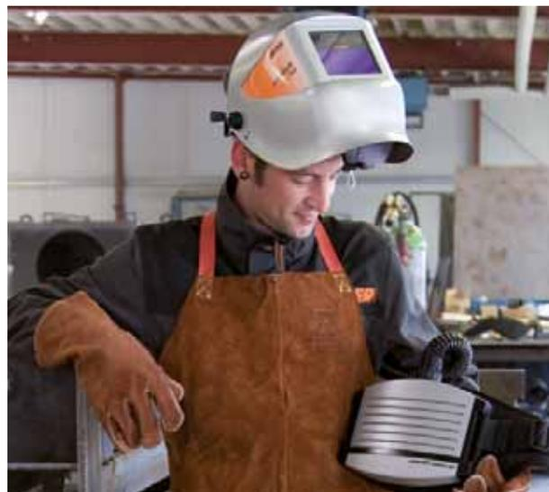
Der KEMPER autoflow XP® besticht durch Leistungsstärke bei gleichzeitig geringem Gewicht und kompakter Bauweise. Die Gebläseeinheit ist an einem bequemen Tragegurt befestigt, der so eng anliegt, dass auch in beengten Arbeitsbereichen keine Probleme entstehen. Ermüdungsfreies Arbeiten, über den ganzen Tag hinweg, ist somit gewährleistet.
