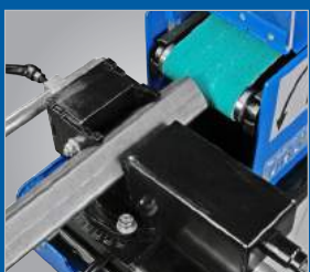
HÁTSÓ RÉSZ PEREMCSISZOLÓVAL, PRAKTIKUS MUNKADARABTARTÓVAL ÉS ELSZÍVÓVAL
