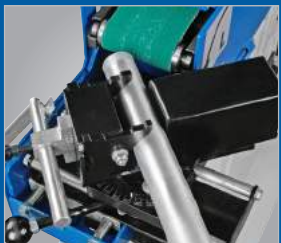
▶ A forgatható pófák lehetővé teszik a biztonságos befogást kerek-, négyzetűd, és lapos acélcsövek esetén. ▶ A prizmapófák megkönnyítik a munkadarabok befogását ▶ A kiegészítő rögzítőprofilok a munkadarabok pontos szorítását segítik, mint például a laposacél vagy a szögletes csövek.
